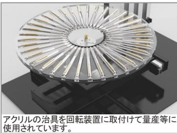
アクリルの治具を回転装置に取付けて量産等に使用されています。
